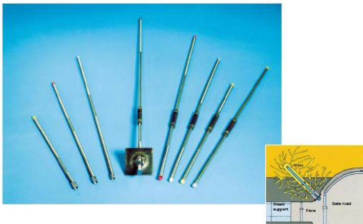
**ПРИМЕНЕНИЕ. ИРМА** изготовлена из стальной неразрезной трубы. На расстоянии 70 см от головки анкера монтируется герметизатор длиной 25 см, который изолирует скважины диаметром до 60 мм.
