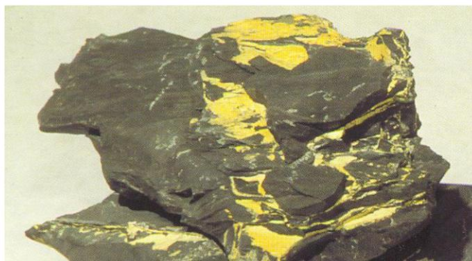
**Органоминеральная смола Геофлекс** состоит из двух жидких компонентов, которые в объемном соотношении 1:1 при помощи насоса подаются отдельно по шлангам, перемешиваются в смесителе и через анкерную систему и герметизатор нагнетаются в упрочняемый массив. Реакция компонентов начинается в смесителе, а полное отверждение полимерной смеси происходит через 3-4 минуты после смешивания компонентов.
